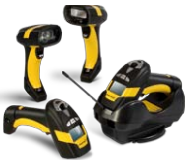
Powerscan 8330 kabelgebunden und Funkversion (über Übertragungsstation und StarModem)
